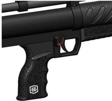
Отводим рычаг взвода до постановки винтовки на боевой взвод, затем вкладываем пулю в пульный лоток или вставляем магазинчик с предварительно заряженными пулями и возвращаем рычаг взвода, тем самым досылая пулю в ствол.
