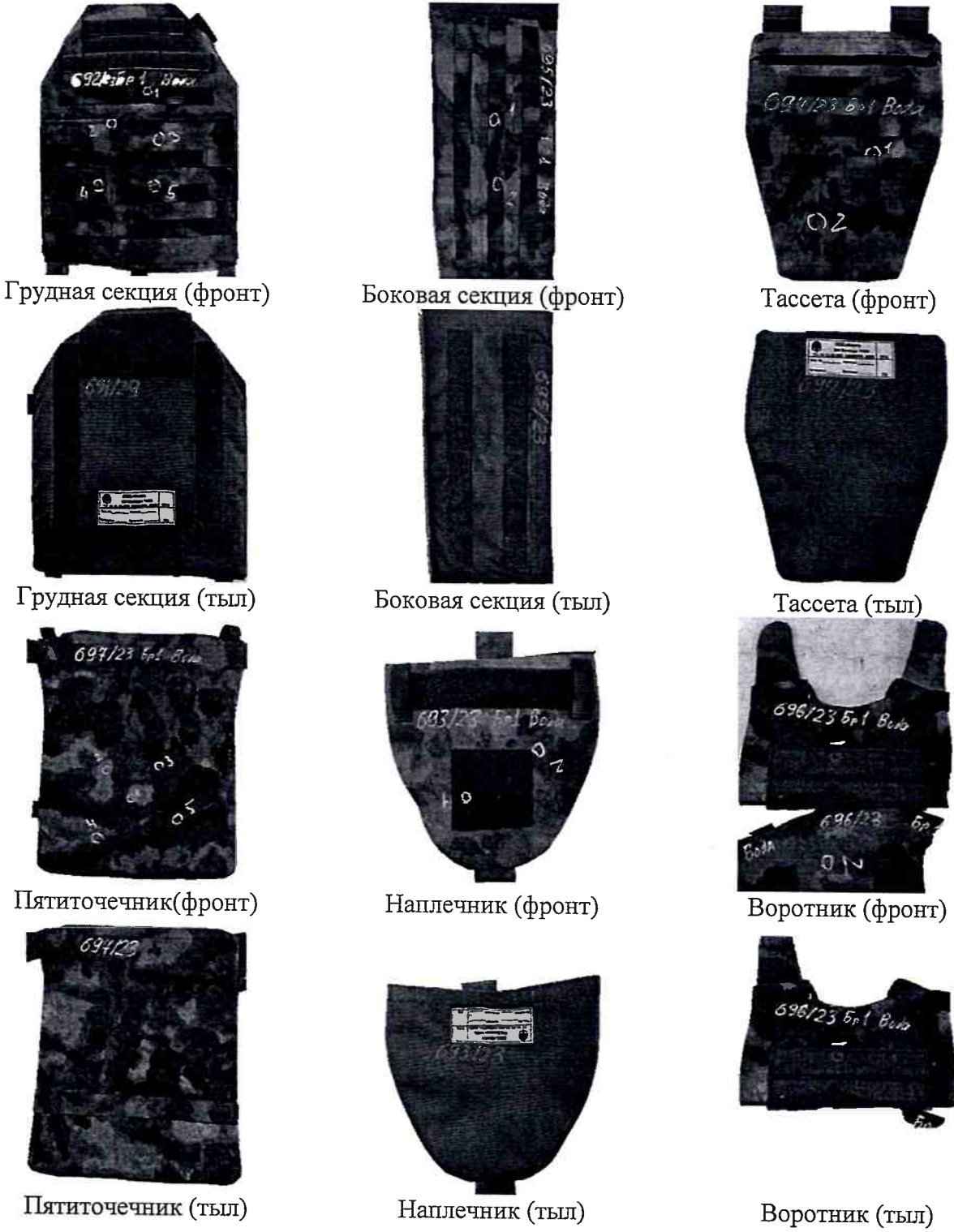
Рисунок 1.1 – Элементы БЖ «Воевода 14/23» после проведения испытаний на противопоульную стойкость (вода)
