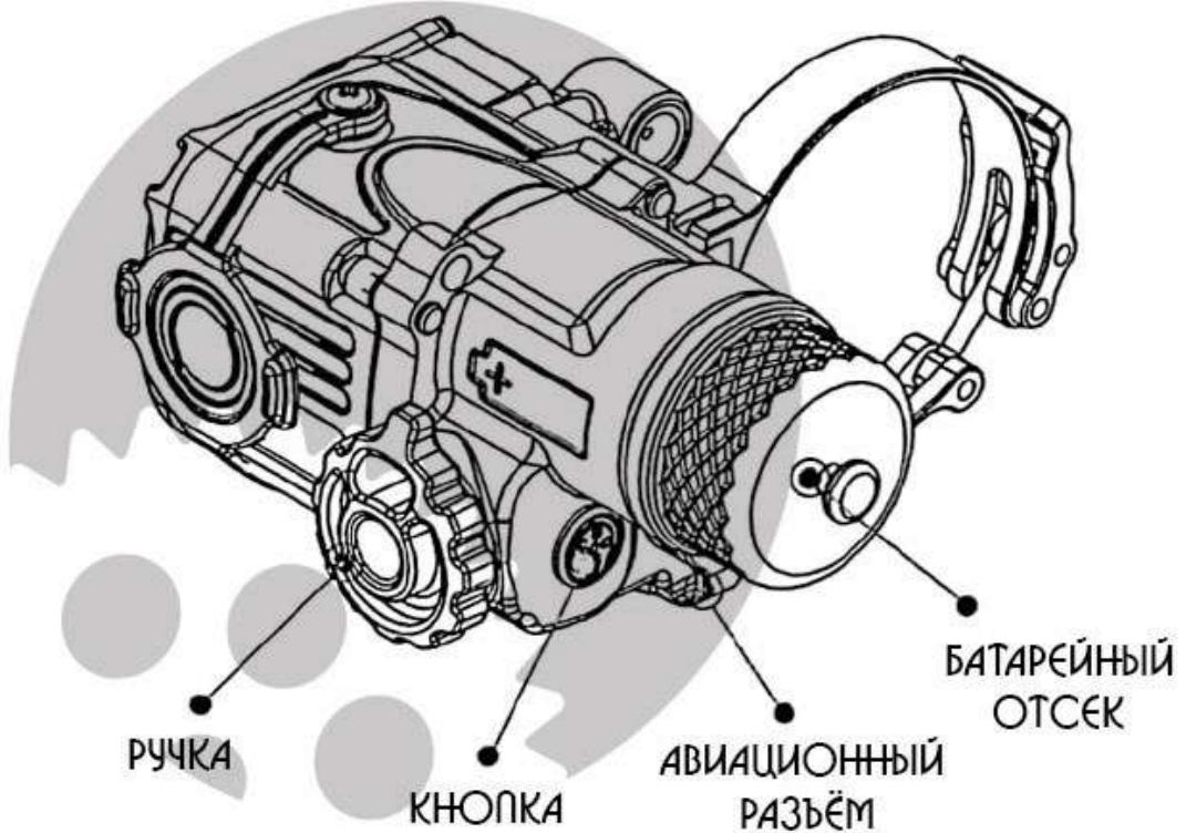
\*ПОСЛЕ УСТАНОВКИ ДВУХ БАТАРЕЕК 18650 НАЖМИТЕ И УДРЖИВАЙТЕ КНОПКУ В ТЕЧЕНИИ ТРЕХ СЕКУНД.ДЛЯ ВКЛЮЧЕНИЯ ПИТАНИЯ УСТРОЙСТВА ПОВЕРНІТЕ РУЧКУ.
