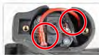
無作動 檢查馬達連接線(需卸下底板)。
