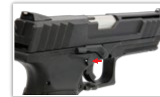
Empuje el selector del seguro hacia la izquierda.
