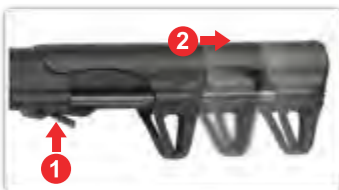
按下伸縮托鈕可以調整槍托長度
