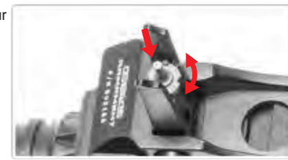
Appuyez sur le bouton pour régler la hauteur. Tournez dans le sens horaire pour élever le point d'impact. Tournez dans le sens antihoraire pour baisser le point d'impact.
