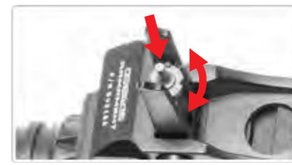
下壓星尖後可以旋轉調整低。 順時針：調高 逆時針：調低
