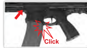
Inserte el cargador en el receptor inferior hasta que escuche un click.
