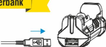
Чтобы запустить функцию Powerbank, подключите кабель в разъем USB Type-A зарядного устройства с установленным аккумулятором Li-Ion, и подключите его к вашему устройству.
