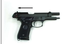
PULL THE SLIDE COMPLETELY TO THE REAR.
