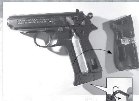
2. Вставьте новый баллон СО2 12 гр. и при помощи шестигранного ключа наколите его в гнезде клапанного механизма.
